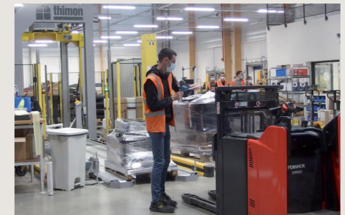
El recolector coloca la paleta en la zona de espera y luego el empaquetador toma el relevo, lo que permite un doble control del pedido y ha reducido a la mitad el número de errores. La máquina de filmación automática es capaz de sellar 40 paletas por hora. El Sello transparente se recicla. En total, el departamento de preparación gestiona 250 pedidos al día, desde un solo sobre con una boquilla hasta un contenedor completo.
