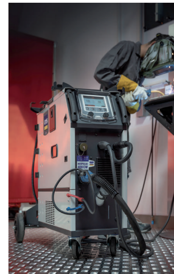
El generador MIG/MAG pulsado Neopulse 400 CW es el último de la gama. Se trata de una solución "todo en uno" con unidad de refrigeración y alimentador de alambre integrados. Tiene trazabilidad nativa de todos los cordones de soldadura.
