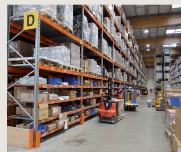
En el segundo modo de almacenamiento, los productos pequeños con un alto índice de rotación se almacenan en estanterías en la zona inferior. Cuando el embalador toma el pedido, el escaner de mano le muestra la ubicación de cada pieza y se define su camino para que sea el más fácil y rápido.
